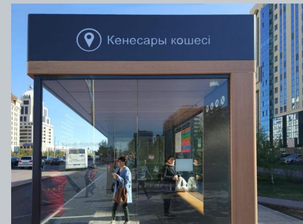
Конструкции остановок выполнены из стальных гнутых металлических профилей, обшивка каркаса – из алюминиевых панелей с полимерным антивандалным покрытием из минерального каленого стекла. Внутри комплекса используется промышленный износостойкий линолеум – антискользящий, а также он долго не истирается, борется с оледенением и не впитывает влагу и запахи.
